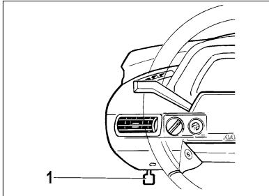
Рис. 14. Рукоятка привода замка капота
