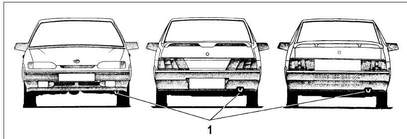
Рис. 32. Проушины для буксировки
