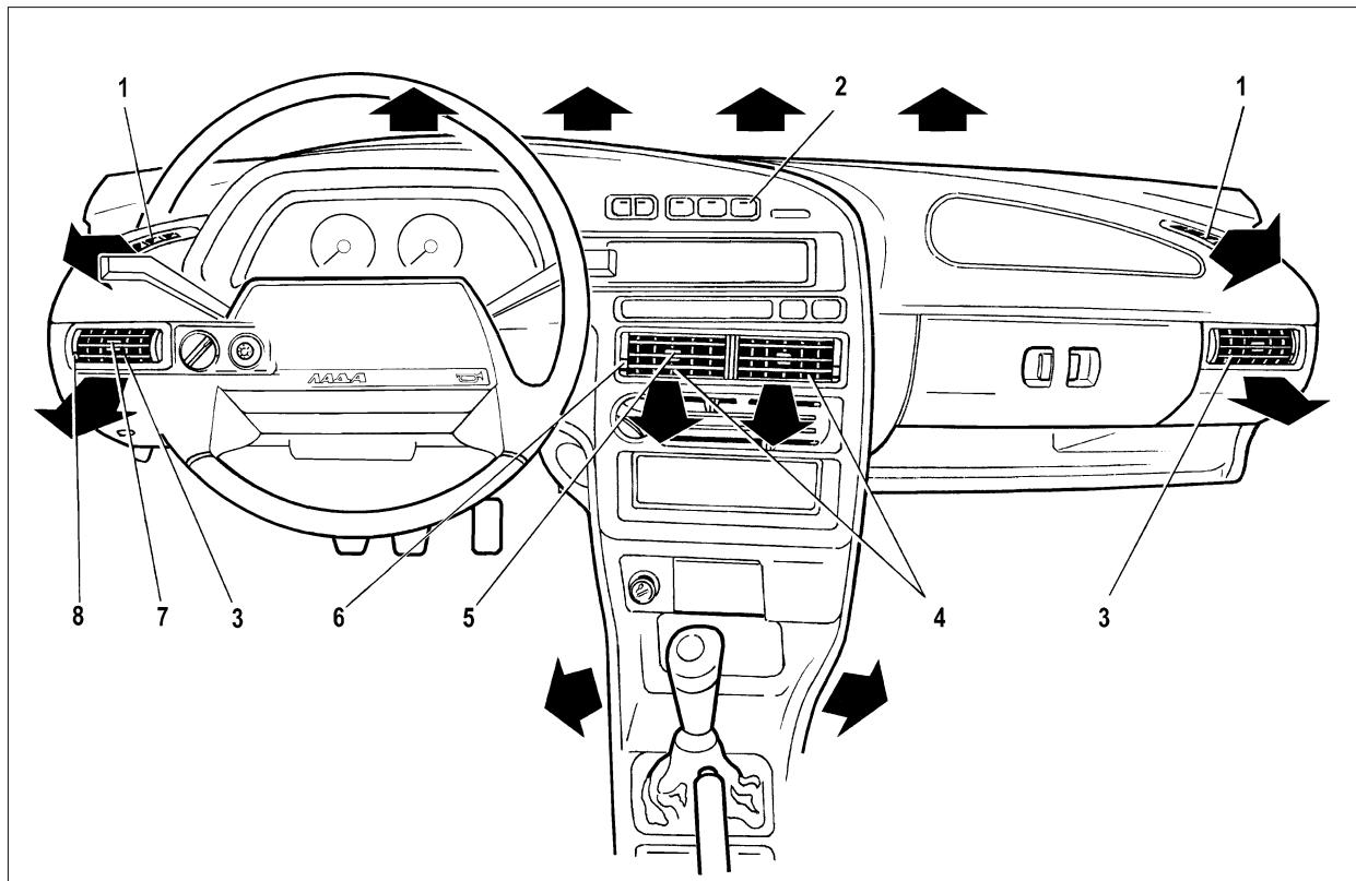
Рис. 29. Органы управления системой вентиляции и отоплением салона
