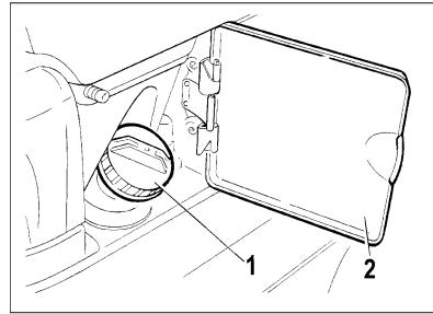
**Рис. 18. Пробка топливного бака**
