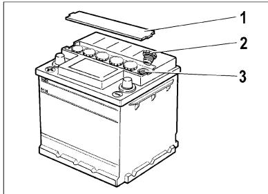
**Рис. 36. Аккумуляторная батарея**
