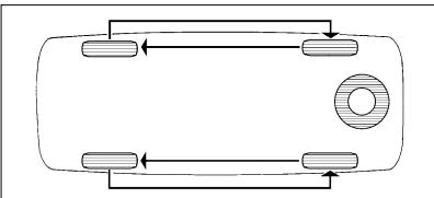
Рис. 39. Схема перестановки колес
