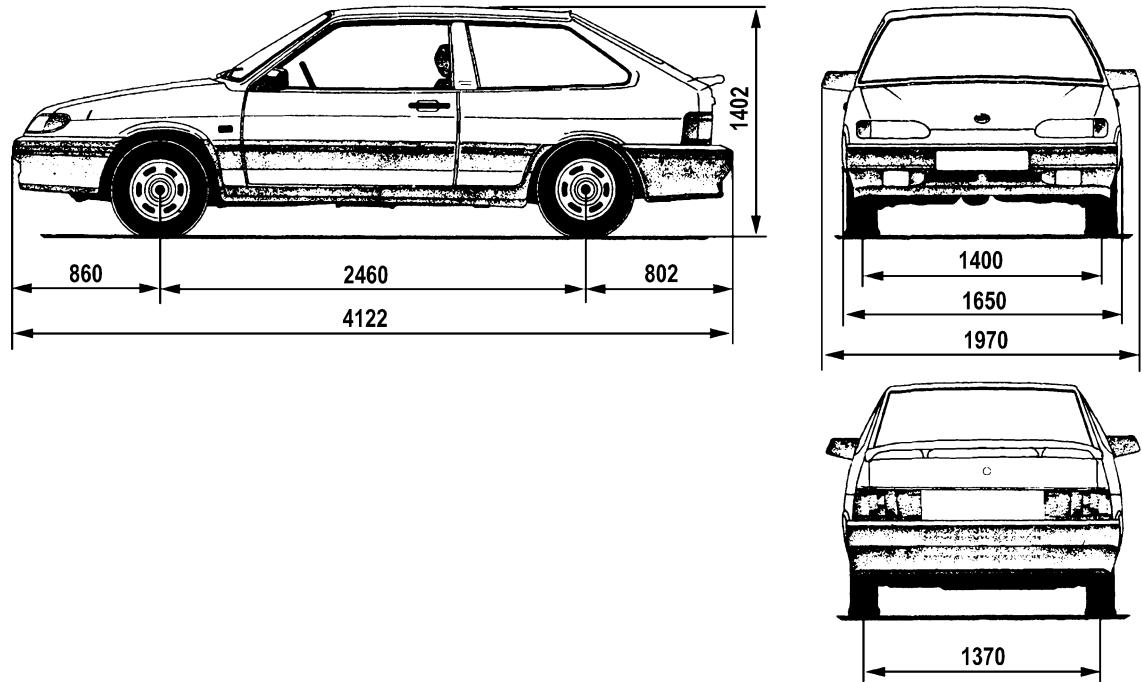
Рис. 52. Габаритные размеры (справочные) автомобиля ВАЗ-2113 и его исполнений
