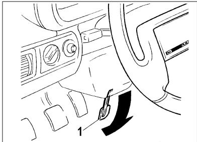
**Рис. 20. Рукоятка регулировки положения рулевой колонки**
