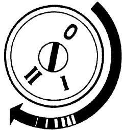
Рис. 23. Положения ключа в выключателе зажигания
